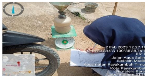
Gambar 1. Penimbangan botol pasir sebelum dituang
