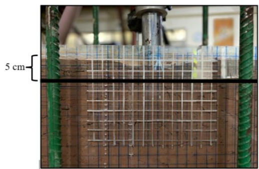
Gambar 4. Tanah dengan Geotekstil Woven kedalaman pada Box Uji 5 cm pada Box Uji
