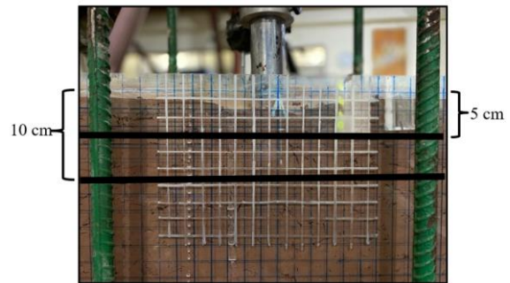
Gambar 6. Tanah dengan Geotekstil Woven 2 Lapis dengan Kedalaman 5 dan 10 cm Pada Box Uji
