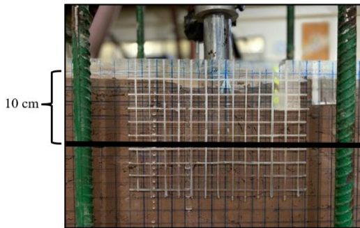
Gambar 5. Tanah dengan Geotekstil Woven kedalaman 10 cm
