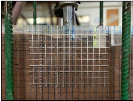
Gambar 3. Tanah Tanpa Perkuatan Geotekstil Woven
