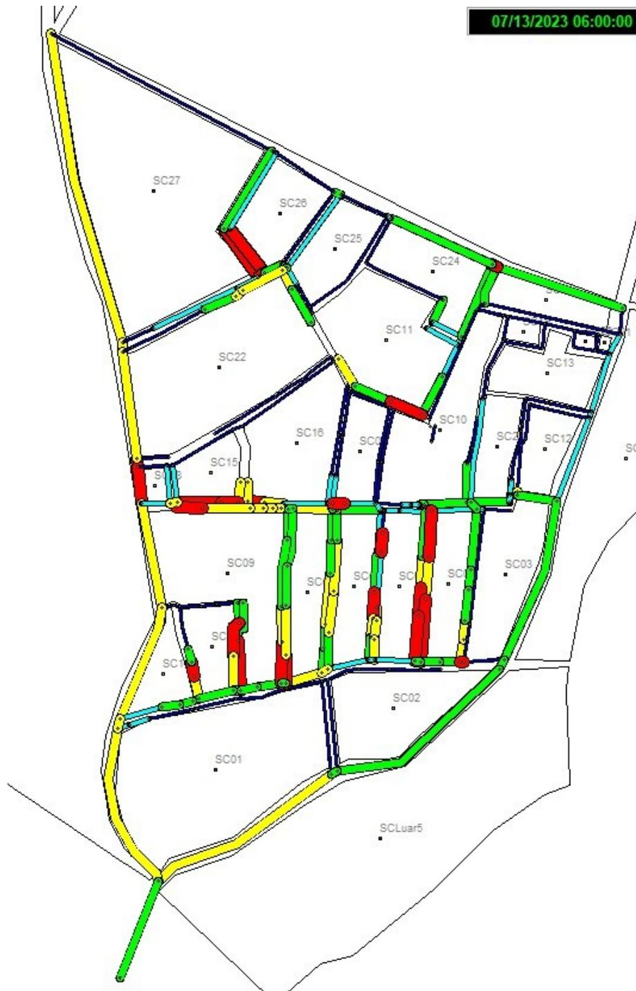
**Gambar 12.** Hasil simulasi kondisi eksisting dengan model EPA-SWMM
